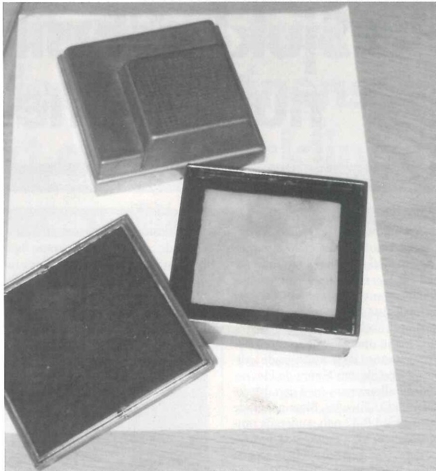
Figur 5: S. Johansson & B. Skanses gammakamera bestod av en flerhålskollimator och en scintillationsdetektor från vilken ljuset registrerades direkt på en fotografisk film. Synfältet var ca 15 x 15 cm 2 .
