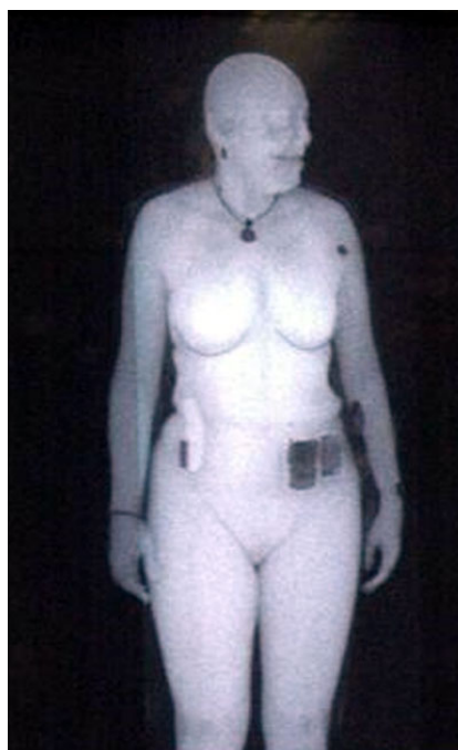
Bild tagen med en backscatterscanner. Metallobjekten avtecknar sig som mörka strukturer och organiska objekt som ljusa.
